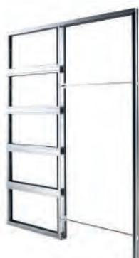
Pour cloisons à ossature métallique et plaques de plâtre, épaisseurs cloisons finie 95 et 98mm, rail en aluminium anodisé et chariots à roulements haute qualité étanches, habillage avec couvre joint intégré, réglage de l'ouverture de la porte breveté, guide bas de porte auto-centré.
