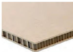
Panneaux composés de 2 panneaux de particules bruts ou mélaminés de 8mm d'épaisseur et d'une âme alvéolaire en carton.
