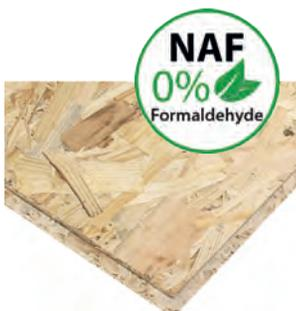
**Dalles OSB :** Les dalles OSB sont composées de lamelles minces et longues, collées entre elles par une résine synthétique et pressées en couches. Les dalles OSB sont rainurées bouvetées. Utilisées en plancher, elles sont environ 40% plus résistantes que les dalles de particules classiques.
